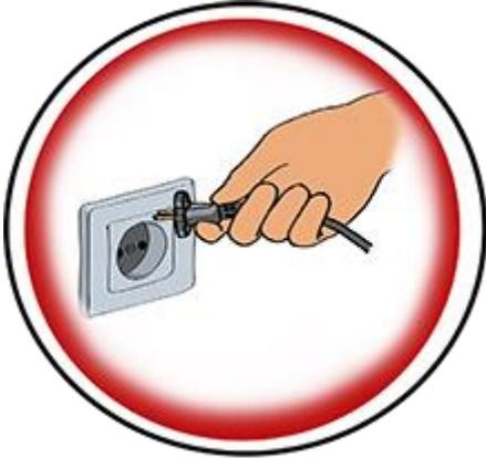
Тянуть штепсель из электророзетки за провод опасней, чем тянуть кога за хвост. Чтобы вынуть штепсель из розетки придумали специальное изолированное расширение. Берись за нее, а второй рукой не давай розетке сдвинуться с места. Розетка бывает закреплена, но из-за частых выниманий может расшататься. Также опасно дотрагиваться до металлических штырей штепселя.
